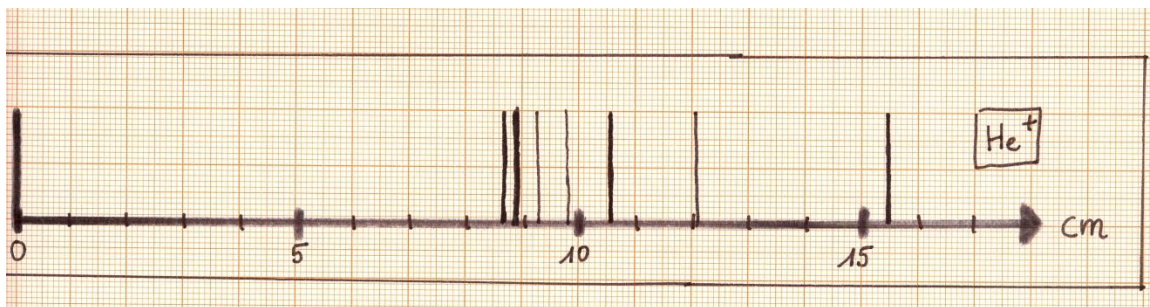
Abb. 1: Verkleinertes Beugungsbild des \text{He}^+ Linienspektrums (historisch auf Schwarz-weiß-Film abgebildet, daher ohne Farbinformation!). Gezeigt ist nur die eine Seite des Spektrums. Die Gitterkonstante beträgt 800 Striche pro mm, die Photoplate ist 25cm vom Gitter entfernt.
