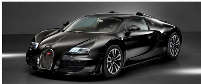
Das **Gewicht** (*gemeint ist die Masse...*) bleibt wie beim Vorgänger bei **1880 kg**. Der **Spritverbrauch** liegt bei **100 Liter pro 100km** bei **Höchstgeschwindigkeit**. Um das Fahrzeug sicher abbremsen zu können, werden Carbon-Keramik-Bremsscheiben eingebaut, die den Wagen aus 100 km/h auf einer Strecke von 31,4 m zum Stehen bringen. (*Informationen und Bild von der VW-Website*)
