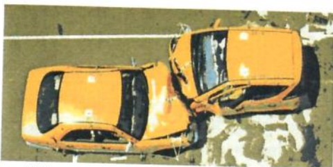
70.1 Vollkommen unelastischer Stoß zweier Autos. Die kinetische Energie wird bei der Verformung in Wärmeenergie umgewandelt.
