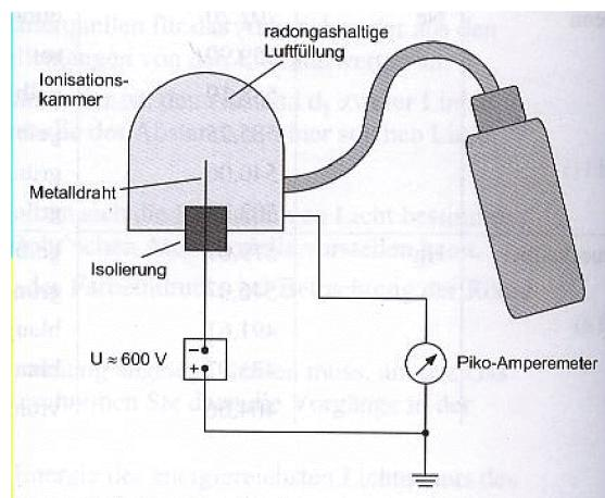
Befindet sich in der Ionisationskammer nur Luft, so fließt ein sehr geringer Strom (Untergrund!), da ionisierte Luft keinen Strom leitet. Wird aber Radongas in die Kammer gepumpt, so fließt sofort ein Strom. Je mehr Radon hinein gepumpt wird, desto größer ist dieser. Die folgenden Messwerte wurden nach einigen „Pumpstößen“ und dann sich selbst überlassener Kammer aufgenommen:
